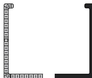
左:軽量化と全体的な剛性確保のためにハニカムを極薄のカーボン板で挟んだ構造になっているが、右:UOVAはシンプルなソリッドの厚板構造を採用。
