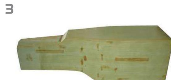
UOVAのマスターモデル=製造用型は抜き勾配をとる必要があるものの、型の製法自体は非常にシンプルなために、低コストかつ、いろいろな形状への対応が容易。
