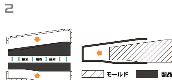
左:一般的なレーシングカーのモノコックは非常に複雑な工程を経て製作されるが、右:UOVAはテーパー形状のモールドにプリプレグを巻きつける簡単な製法を採用。
